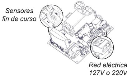
**NOTA:** Otras conexiones como los cables del motor, sensor encoder, entre otras, ya están listas de fábrica. Si es necesario realizar algún cambio o mantenimiento, consulte el manual completo para obtener más detalles.
