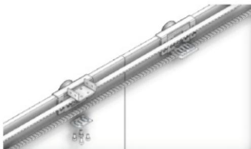
Após centralizar as folhas, prender a correia na segunda folha (Fig. 2). Com as duas folhas presas a correia ajuste a tensão da correia, para mais ou para menos, regulando o esticador. A tensão da correia deve ser a suficiente, para que a mesma não pule os dentes da polia dentada do motorreductor. Movimente a porta manualmente, verificando se a correia não solte do motorreductor, se caso ocorrer estique novamente a correia.
