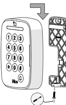
3 - Após concluir a passagem dos fios, encaixe o produto na base. Primeiramente na parte superior e depois na parte inferior. Em seguida, fixe as partes através de um parafuso, localizado na parte inferior, conforme a imagem ao lado.
