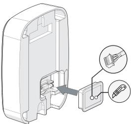
2 - Para a passagem dos fios da instalação já existe um orifício na borracha de vedação. Porém, se este orifício for insuficiente para a instalação, aumente-o com o auxílio de um estilete, conforme imagem ao lado;
