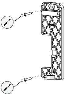
1 - Fixe a base do produto no local desejado da instalação (ex. parede) através de dois parafusos, conforme a imagem ao lado;
